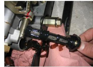
**Filtre à gazole : Le remplacer toutes les 500 heures. Il est situé à l'intérieur du réservoir.**
