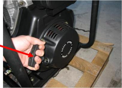
Appuyer sur le décompresseur pour le mettre en position basse.
