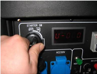
Pour arrêter le moteur, tourner le contacteur ou l'interrupteur (selon version) sur "OFF " pour stopper l'alimentation de Gas-Oil et arrêter ainsi le moteur.
