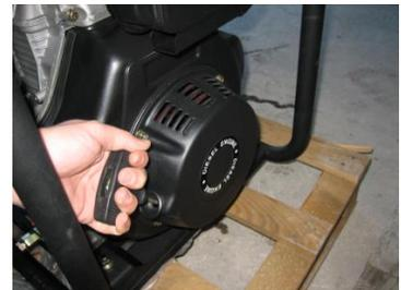
Essayer à 3 ou 4 reprises cette manipulation pour démarrer votre machine. Si cela ne fonctionne pas cela signifie que l'opération de purge n'a pas été correctement effectuée et que de l'air se trouve toujours dans le circuit d'injection. Dans ce cas il est impératif de recommencer l'opération de purge et de refaire une tentative de démarrage
