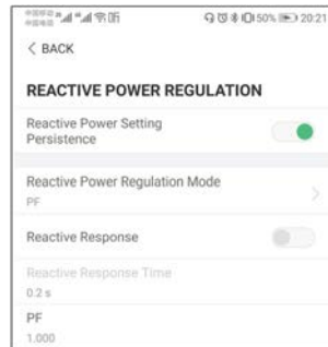
figure 7-17 Régulation de la puissance réactive
