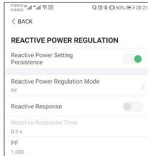
Figura 7-17 Regulación de potencia reactiva
