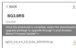
Paso 5 Vuelva a la pantalla **Firmware Download**, pulse
