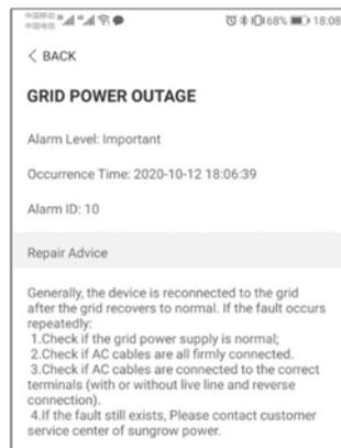
Figura 7-9 Información detallada de alarma de falla
